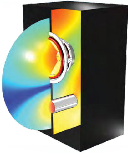
图2 仿真结果显示了扬声器驱动器壳体的声压分布。
