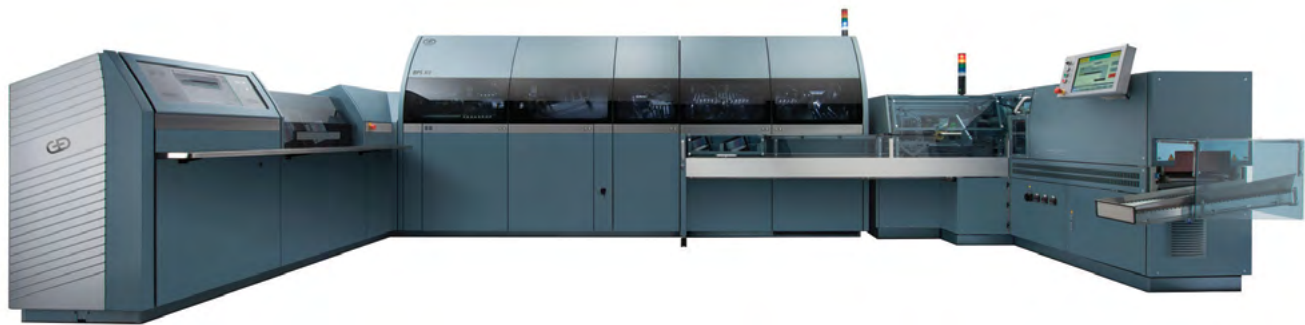
图 1 BPS X9 是世界上最快的纸币处理系统，每秒可处理 44 张纸币，每小时的有效吞吐量超过 15 万张。中央模块的尺寸为 1.9 米 x 5.7 米 (高 x 宽)。
