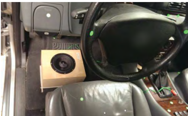
图 1 放置于车内的扬声器, 用于测量车厢内的声压波。
