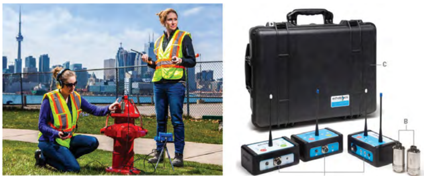
图2 LeakFinderST™ 相关仪是一款简单易用、体积小巧的泄漏噪声相关仪。
