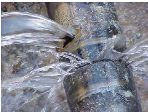
图 1 检测中的泄漏管道 (左); 泄漏检测设置示意图 (右)。泄漏点位于间距为 D 的两个传感器之间。泄漏噪声沿两个方向传播, 相关仪测量了声音到达每个传感器所需的时间。根据管道中的声速, 即可推算出确切的泄漏位置。图注: Sensor - 传感器; RF Transmitter - 射频发射器; Cross-correlator - 互相关仪
