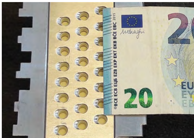
图4 由24个发射器组成的阵列可以发射通过纸币的超声信号。插图 为20欧元的纸币。
