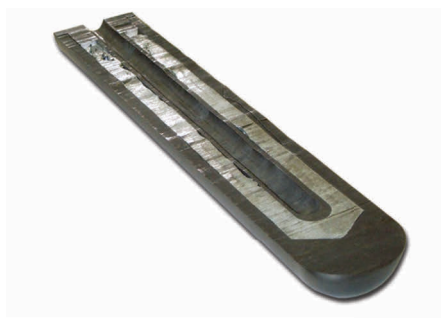
图 1：典型固定点装置的截面，显示了石墨容器、金属锭和用于插入温度计的中心孔。
