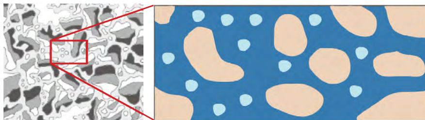
图 2. 将米粒描绘为多孔的弹塑性固体, 其中液态水 (深蓝色) 会发生毛细扩散、对流和相变; 由水蒸气和空气组成的气体 (浅蓝色) 会发生主体流动、二元组分扩散和相变; 由固体淀粉组成的结构骨架 (浅棕色) 会发生大形变。
