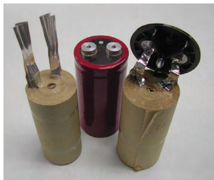
图 1. 铝电解电容器。电解质绕组由铝箔和纤维素隔膜构成，并呈现热各向异性。
