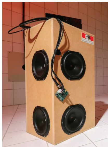
图 1. 主动式电声谐振器原型。图片来源: EPFL/Alain Herzog。
