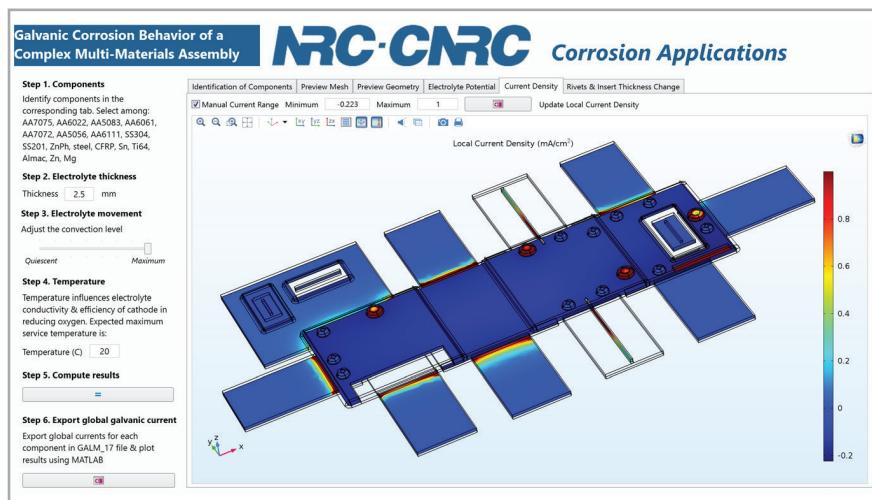
图 9. 用于分析复杂多材料装配电偶腐蚀行为的仿真 App。上图: 整个装配中的电解质电位。下图: 整个装配中的电流密度。
