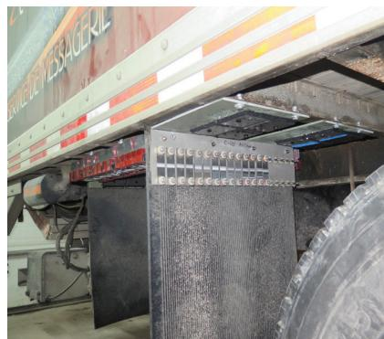
图 2. 上: 经过一年在役暴露实验后, 由碳纤维增强聚合物 (carbon-fiber-reinforced polymer, 简称 CFRP) 和 6000 系列铝合金制成的多材料叠加式装配制成的车身上的电偶腐蚀情况。下: 用于车辆运行测试的汽车样件常见安装方式。
