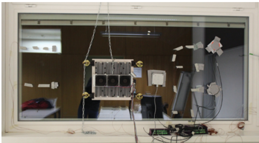
图2. 波曾-博尔扎诺自由大学生活实验室的实验装备, 包括两个热通量板, 一个由因斯布鲁克大学设计的用于测量总热通量的设备, 以及几个用于玻璃表面和空气温度测量的热电偶。
