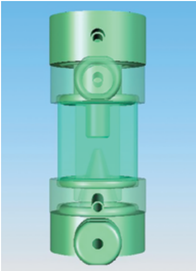
图 4 微孔电极系统的 CAD 模型,使用 CAD 导入模块导入到 COMSOL Multiphysics®。
