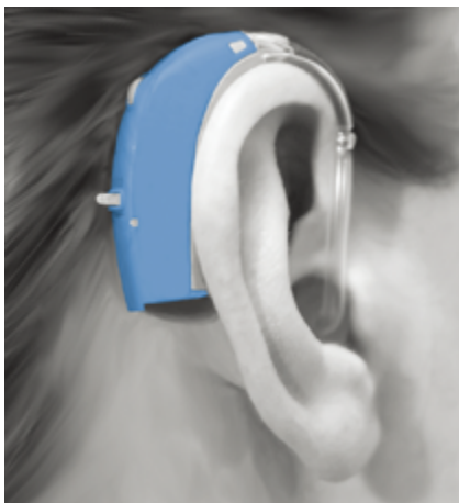
图 1 标准的耳背式助听器由麦克风、隔振装置、受话器等元件组成。由于元件布局过于紧凑，容易产生负面的声学学和力学反馈。图片由楼氏电子公司提供。
