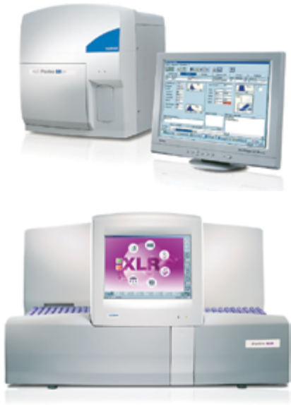
图 2 Pentra 系列的两款血液学分析仪 ABX Pentra 60C+ (上) 和 Pentra 80 XLR (下), 采用了微孔电极系统, 通过阻抗测量来进行血液粒子的数量计数和大小测量。
