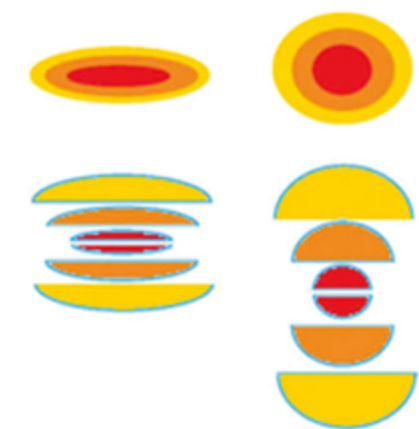
图 6 折射率梯度的有限多层简化图，每层相当于折射率不变的等效晶状体。左侧为远视状态时的示意图，右侧为近视状态。颜色代表折射率的值，最高值用红色表示。
