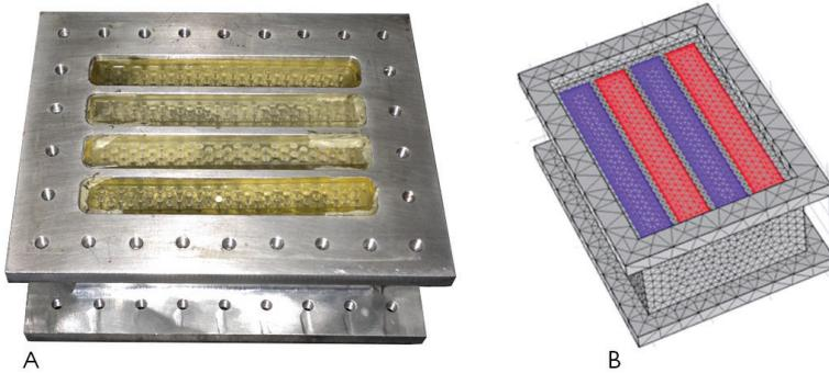
图 1:(A) 四道 IBD 照片。(B) IBD 的网格化 COMSOL 模型。紫色区域表示湿层, 红色表示干层。
