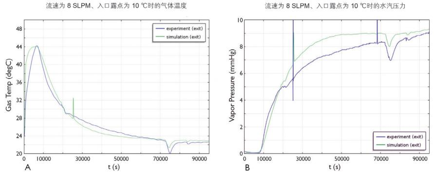
图 3：出口处空气的仿真结果，显示了 (A) 气体温度，(B) 水汽压力。
