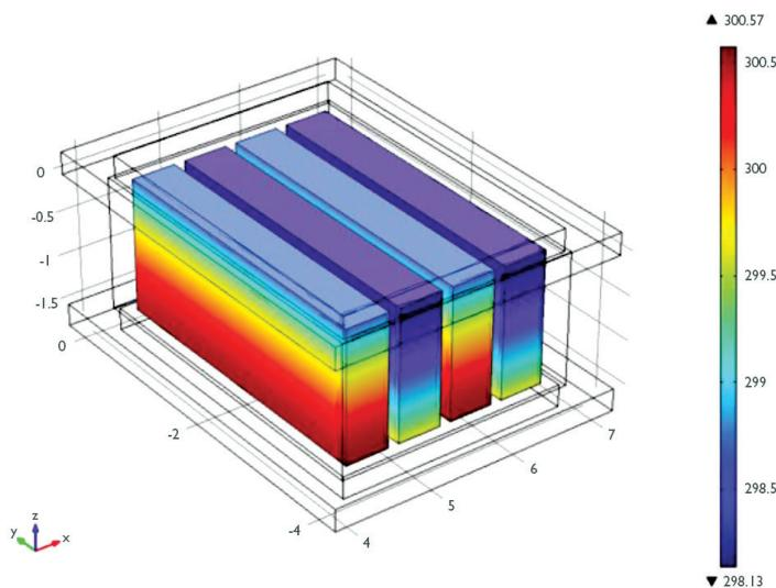
图 2: 仿真结果显示了每个填充层中的温度 (K)。第一和第三道包含向下流动的湿空气, 第二和第四道包含向上流动的干空气。
