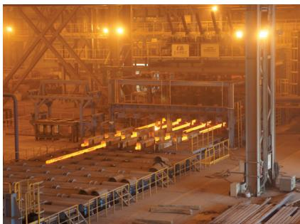
图 1：连铸机的输出辊道，凝固后的铸坯被切割和输出。
