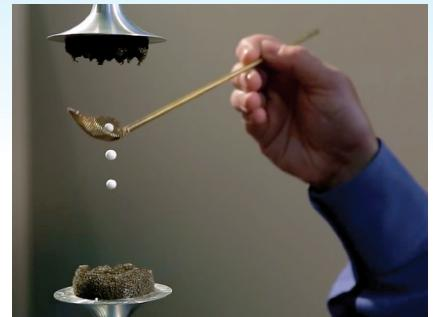
图 1：声悬浮器产生使液滴悬浮的驻立声波。悬浮器包含两个换能器，每个换能器均涂有一层薄薄的用于控制波型的泡沫。
