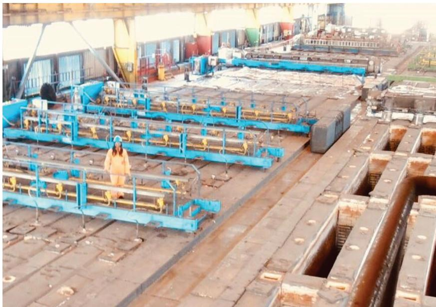
图 1 Aluchemie 公司的阳极焙烧炉。
